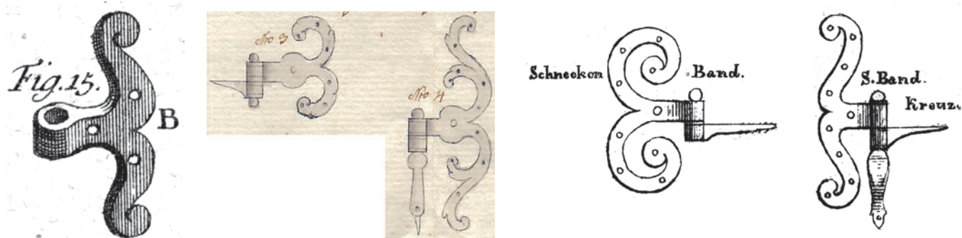
Obr. 13: a – vlevo Duhamelův S-závěs (převzato z H-L. Duhamel du Monceau, o. c. v pozn. 4, tab. 13, obr. 15 B); b – vpravo Renversova nabídka dveřního kování z roku 1795, vlaštovčí ocas a S-závěs (na listu nejsou blíže pojmenovány) se závěsníky – bez opěradla i s opěradlem (HKA Wien, Kommerz Böhmen).
