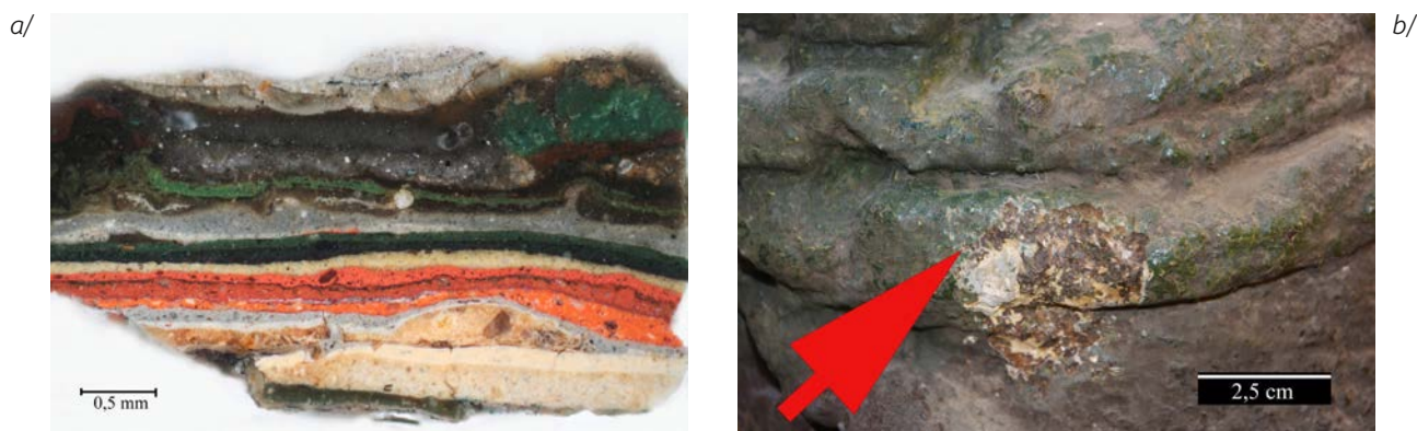
Obr. 34 Příklad velkého počtu dochovaných povrchových úprav zaznamenaných mikroskopicky na nábrusu odebraného vzorku (a/ asi 40 vrstev), které není možné přesně rozlišit ani zdokumentovat stratigrafickou sondou nebo zjistit jejich optické vlastnosti či materiálové složení neinvazivním způsobem, b/ detail místa odběru vzorku.
