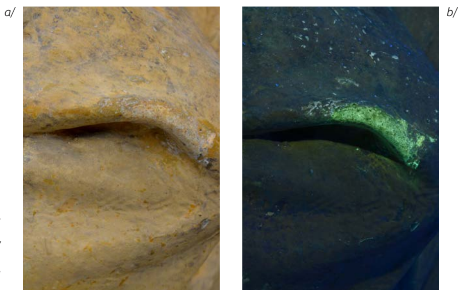
Obr. 19 Detail štukové výzdoby, a/ bílé světlo, b/ UV fluorescence. Na UV fluorescenčním snímku je jasně patrná oblast vyznačující se charakteristickou zelenou/zeleno-žlutou UV fluorescencí, poukazující na retuš se zinkovou bělobou.
