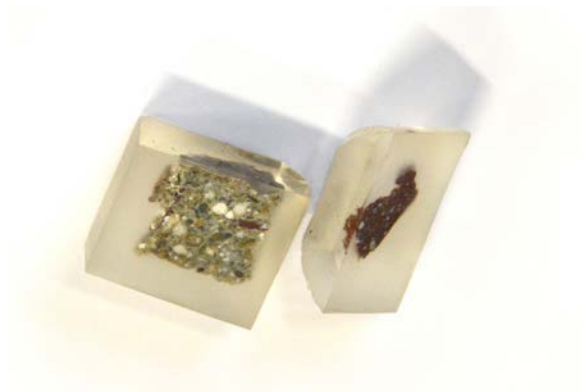
Obr. 42 Leštěné příčné řezy vzorky, a/ výbrusy vzorků béžového a hnědo-červeného štku přilepené na podložní sklo, b/ nábrusy stejných vzorků.
