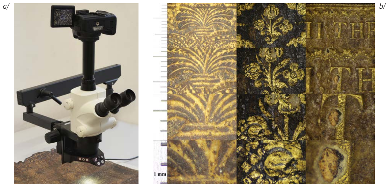
Obr. 15 Ukázka neinvazivního průzkumu pomocí stereoskopického mikroskopu (a/) s mikrosnímky detailů zdobení usně (slepotisk, pozlacovačské techniky) v různých zvětšeních (b/). K získání mikrosnímků bylo použito zvětšení stereomikroskopu 8,3×, 10×, 20× a 40× (od shora dolů).
