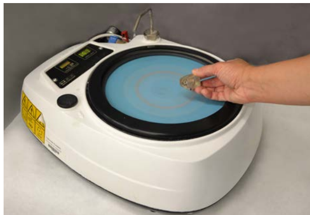
Obr. 41 Příprava nábrusu na brusce, leštění vzorku.
