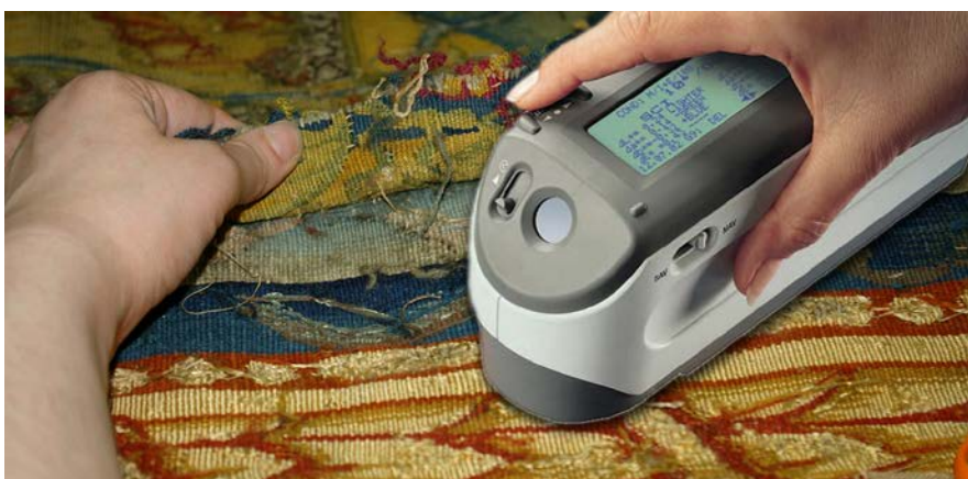
Obr. 31 Měření barevnosti ručním UV-VIS spektrofotometrem (kolorimetrem) na tapiserii. 82
