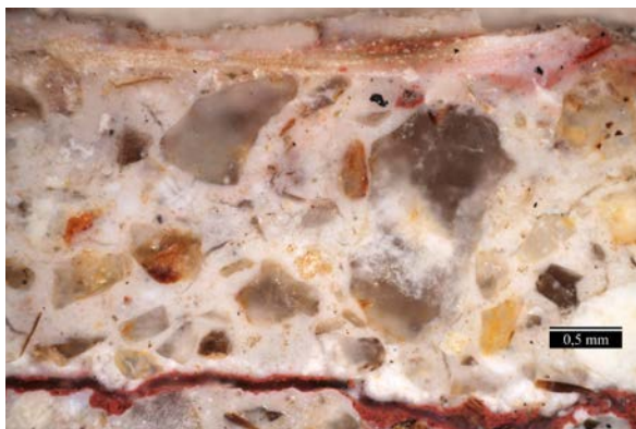
Obr. 43 Optická mikroskopie, a/ nábrus štukových vrstev v odraženém bílém světle (reflexe), b/ výbrus stejného vzorku v procházejícím bílém světle (transmise, II nikoly).
