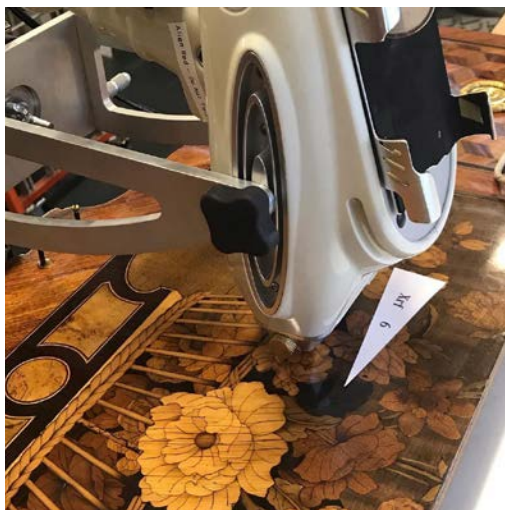
Obr. 29 Měření ručním rentgen-fluorescenčním spektrometrem, přístroj je připevněn na stativu. 74
