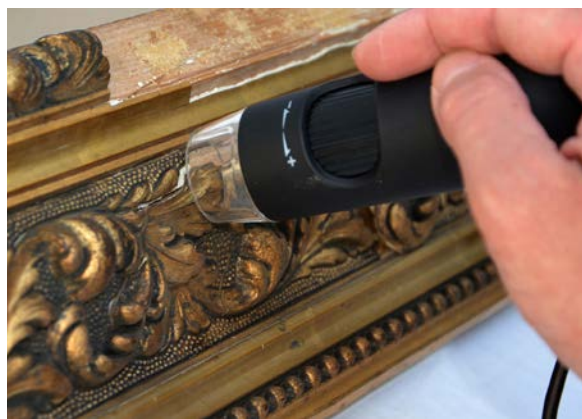
Obr. 36 Mikroskopická (USB mikroskop) dokumentace místa odběru vzorku.
