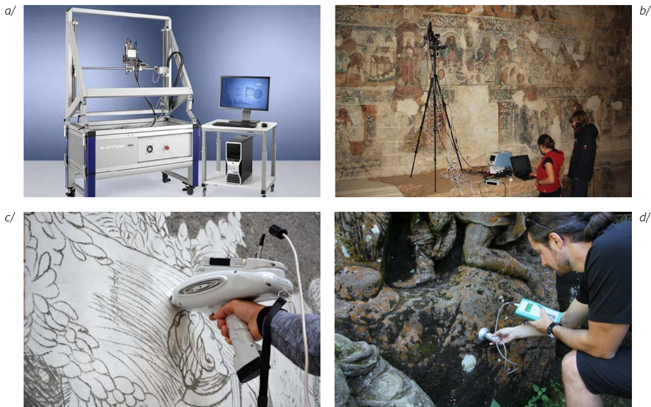
Obr. 4 Příklady přístrojového vybavení neinvazivního průzkumu a/ transportovatelný skener 14 , b/ přenosný Ramanův spektrometr 15 , c/ ruční rentgen-fluorescenční (XRF) analyzátor, d/ ruční měření vlhkosti mikrovlnnou metodou.
