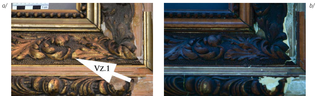
Obr. 35 Příklad fotografické dokumentace místa odběru vzorku, a/ bílé světlo, b/ UV fluorescence.
