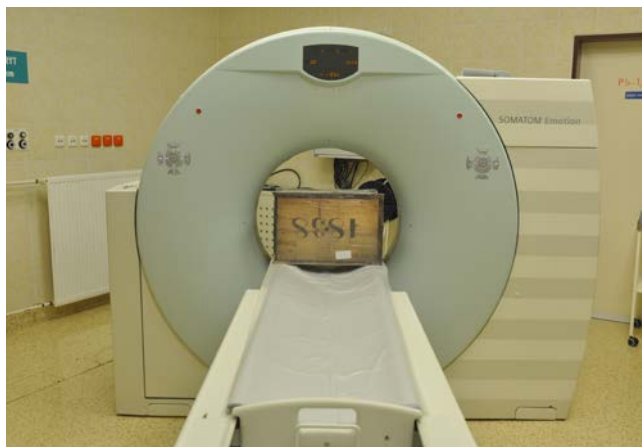
Obr. 24 Ukázka průzkumu předmětu rentgenovou výpočetní tomografií. 62
